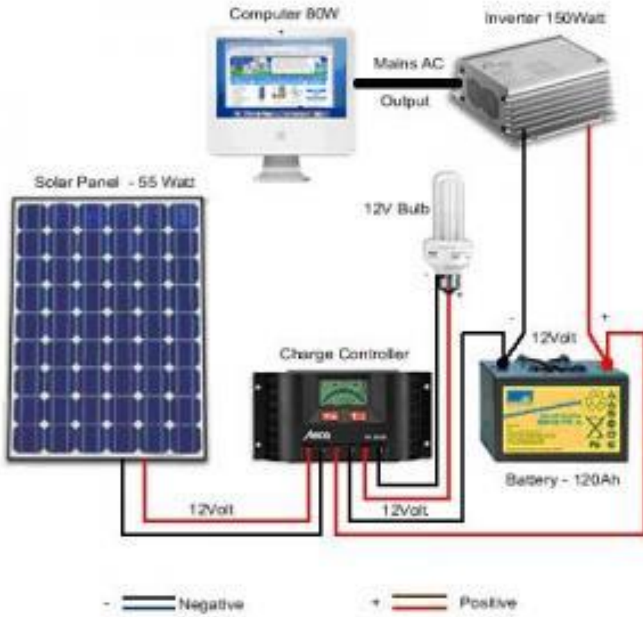
شكل (3-15) نظام بسيط يوضح فكرة الخلايا الشمسية بشكل متكامل (الأخرس، 2014)
